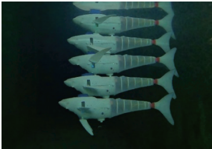
图 10 仿生鲫鱼下潜试验图
